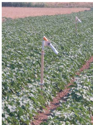
Αισθητήρες υπέρυθρης ακτινοβολίας εγκατεστημένοι σε καλλιέργεια βάμβακος.
