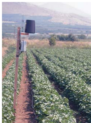
Ο σταθμός βάσης του συστήματος Smart Crop συλλέγει δεδομένα από τους υπέρυθρους αισθητήρες.
