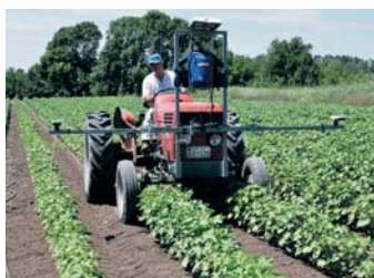
Μέτρηση με τους πολυφασματικούς αισθητήρες στο φύλλωμα της καλλιέργειας βάμβακος.
